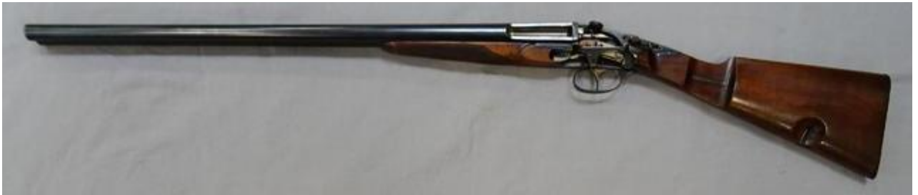
Fusil superposé DARNE Didactique R10 . Calibre 16. Canon droit de 63.5cm, crosse 34 cm. Pièce rarissime, réalisée par la maison mère pour expliquer le mode de fonctionnement. Vendu 4 080€
